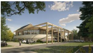
D'une surface totale de 2.500 m<sup>2</sup>, le bâtiment à construire sera habillé de béton au niveau socle et l'étage sera habillé de bois avec un bardage posé verticalement.
